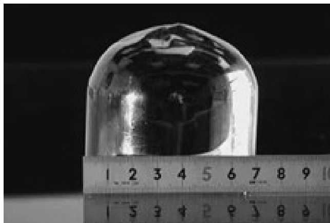
Figur 7. Enden av ein utstøypt bolt av \text{Pd}_{40}\text{Ni}_{10}\text{Cu}_{30}\text{P}_{20} , med rekordstor diameter, 72 mm [2]. For dei billegare, jernbaserte materiala er oppnådd bolt diameter førebels berre 1/4 av dette.
