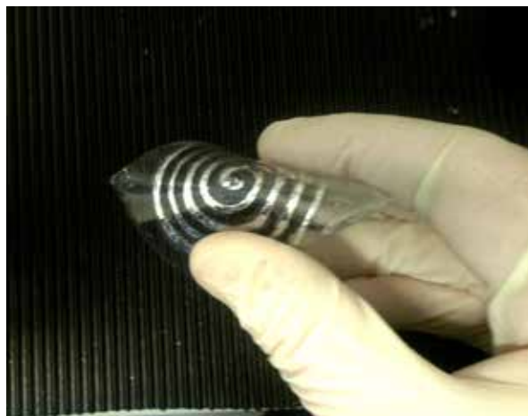
Figur 1. En spiralformet spole laget av 100 μm tykt flytende metall (EGaIn) innkapslet i elastomer (silikon).
