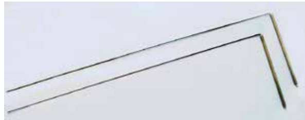
^ Figur 4. Søkevinkel lages gjerne av sveisetråd bøyd i rett vinkel og ene enden tredd gjennom et hult metallrør.
