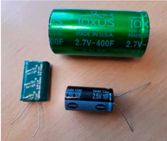
Figur 2. Tre superkondensatorer med kapasitanser 5 F, 10 F og 400 F. Diameteren på den mørkeblå 10 F kondensatoren nederst i bildet er omtrent 1 cm.
