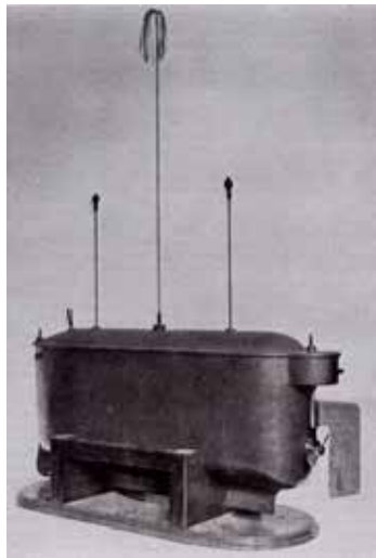
Figur 4. En radio- styrt båt konstruert av Tesla. (Bilde: Wikipedia Commons/ Nikola Tesla)
