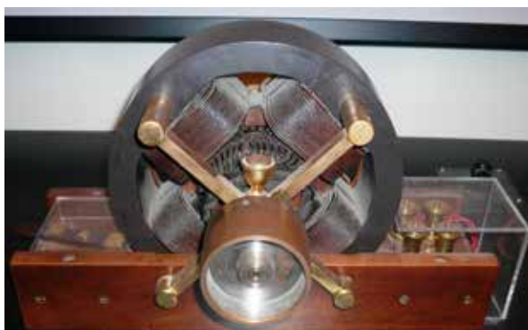
Figur 2. Modell av Teslas første induksjonsmotor utstilt i Tesla-museet i Beograd. (Bilde: Wikipedia Commons/Ctac)
