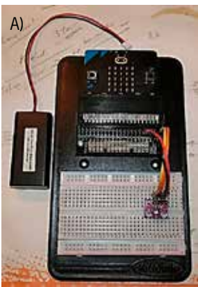
Figur 4. Trykksensoren består av en piezo-resistiv skive med elektroder (til høyre). Til venstre sees elektronikken.
