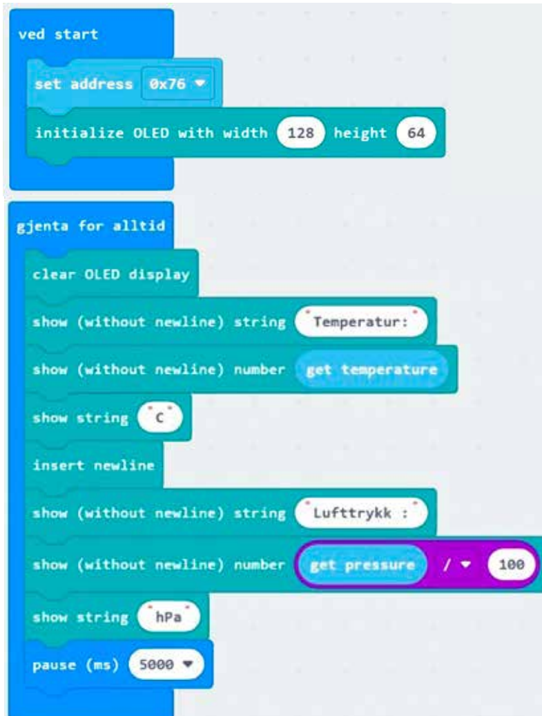
Figur 8. Program som leser av og viser verdien for temperatur og lufttrykk med tekst og benevnning på OLED-displayet.
