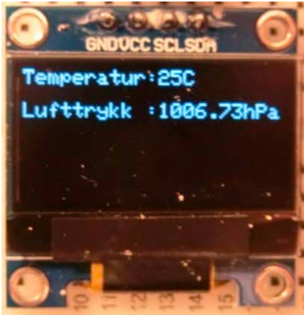
Figur 9. Temperatur og trykk vist på OLED-displayet.
