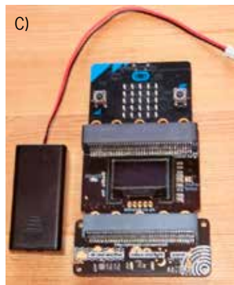
Figur 5. Til venstre, enklest mulig oppkobling med kun BMP280. Til høyre, høydemåler supplert med et bedre display (SSD1306) enn det innebygde LED-displayet til micro:bit.
